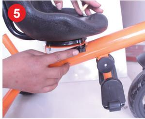
5 Instalați scaunul, introduceți șurubul scaunului în orificiul șurubului corespunzător și fixați-l cu butonul negru.
