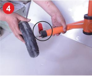
4 Πρώτα τοποθετήστε τα φρένα στην υποδοχή πλαισίου και, στη συνέχεια, τοποθετήστε τον πίσω τροχό στον σφιγκτήρα
