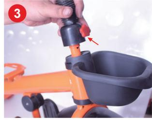
3 Puneți mânerul frontal în coșul din față și aliniați găurile șuruburilor pentru a strânge capacul șurubului.
