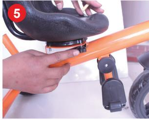
5 Εγκαταστήστε το κάθισμα, τοποθετήστε τη βίδα του καθίσματος στην αντίστοιχη οπή και στερεώστε το με το μαύρο κουμπί.
