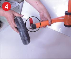
4 Mai întâi instalați frânele pe fanta cadrului, apoi introduceți roata din spate în clemă.
