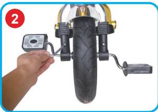
Inserte la rueda delantera en la horquilla delantera y fíjela con tornillos y apriétela.
