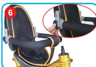
Introduceți mânerul în orificiul de pe ambele părți ale scaunului, răsuciți butonul roșu cu mâna și apăsați cu degetul mare.
