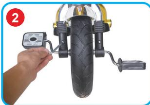
Introduceți roata din față în furca din față și fixați-o bine cu șuruburi.
