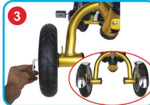
Fissare la ruota posteriore al telaio e stringerla, poi inserire il parafango sul telaio.
