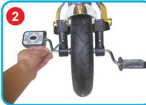
Stecken Sie das Vorderrad in die Vorderradgabel, befestigen Sie es mit Schrauben und ziehen Sie diese fest.
