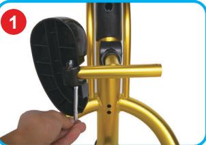
Premere il pedale sul telaio. Avvitare e stringere le viti.
