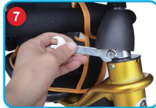
Setzen Sie die Karte in die Kraft ein, setzen Sie das Auto ein und ziehen Sie es mit dem Sechskant fest.
