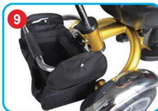
Fixați coșul din spatele cadrului și strângeți-l cu o șurubelnită.
