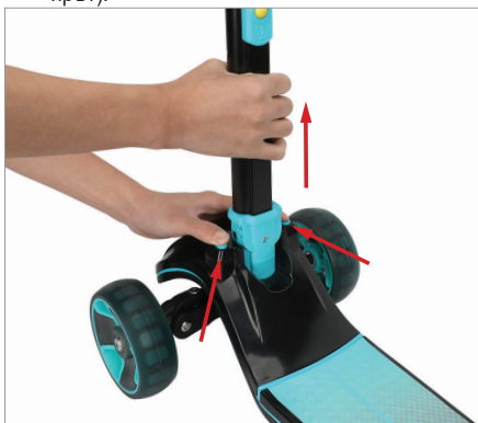
⑧ При сгъване натиснете двата бутона в предната част на тротинетката и издърпайте кормилото.
