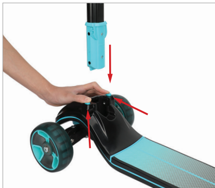
② Πιέστε προς τα κάτω τα 2 κουμπιά στο μπροστινό μέρος του σκούτερ και μετά τοποθετήστε τη ράβδο.
