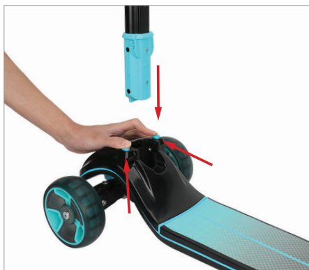
② Presionar hacia abajo los 2 botones en la parte delantera del scooter, luego insertar la varilla.
