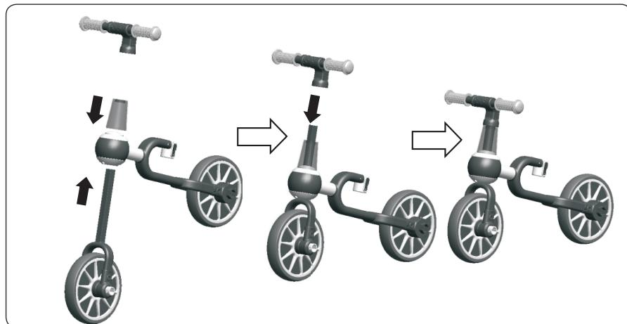
2. Insertar el tubo inferior del asiento en el orificio de montaje correspondiente del cuadro, como se muestra en la imagen.
