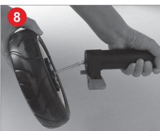
Τοποθετήστε τον τροχό στο πλαίσιο.
