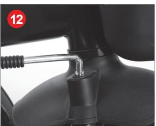
Presione el cable de dirección en la horquilla delantera.
