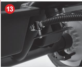
L'autre côté est monté sur le levier de direction.
