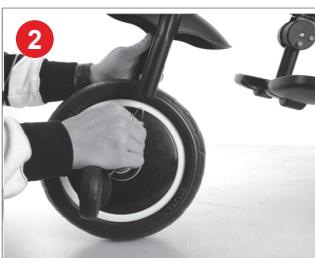
Installare le ruote anteriori sul telaio.
