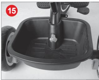
Installez le panier arrière sur le cadre et serrez les vis.
