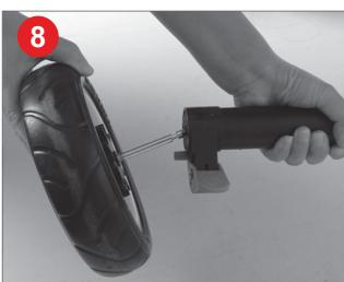
Installare la ruota sul telaio.
