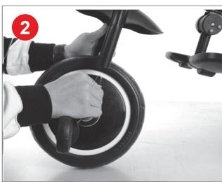
Instalați roata față pe cadru.
