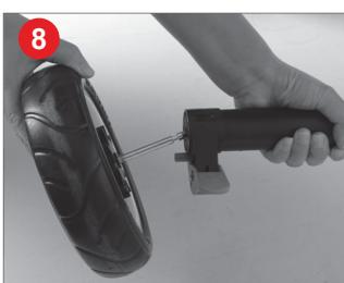
Instalați roata pe cadru.
